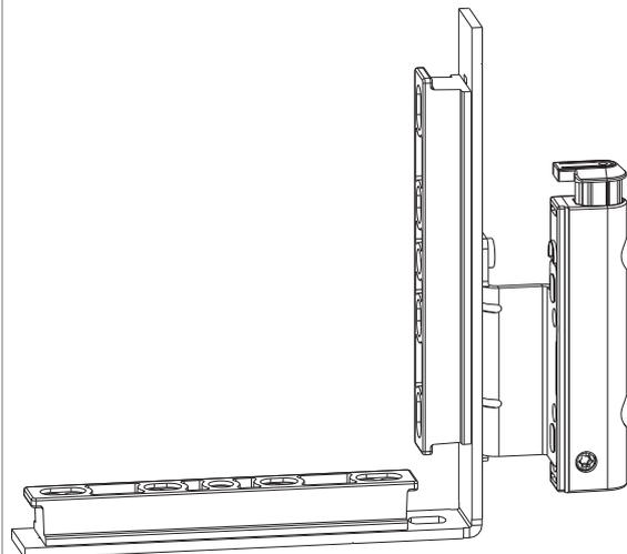
Bei Ecklagerbänder DT/TO für Fenstertüren können die Winkelbandunterlagen 40485 oder 40486 verwendet werden!
