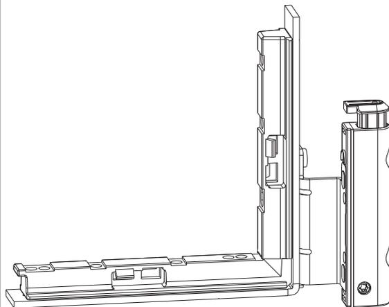
Bei Ecklagerbänder AS/DT/TO können die Winkelbandunterlagen 40485, 40486, 44234 oder 41262 verwendet werden!
