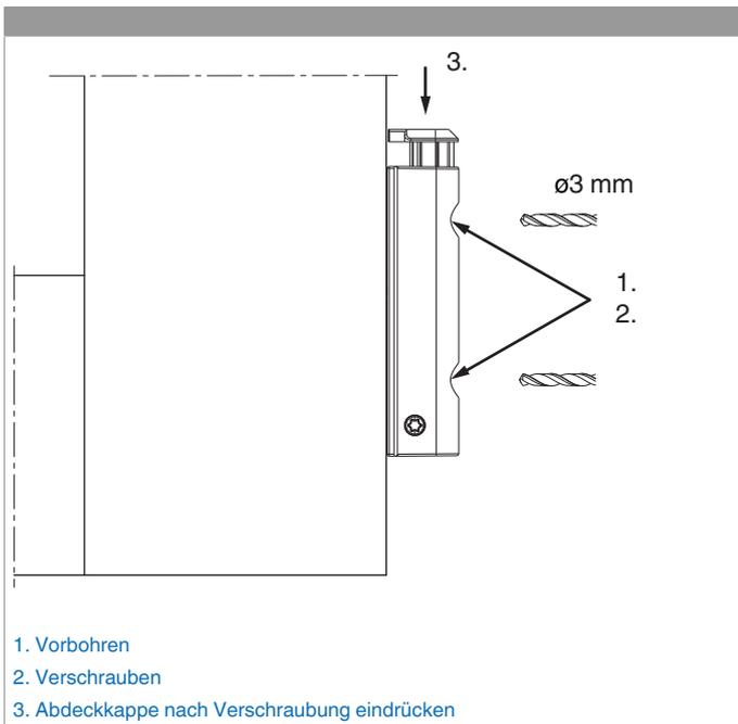
Das Ecklagerband DT mit ÜV an den Überschlag anlegen, die beiden Löcher am Überschlag vorbohren und verschrauben.
